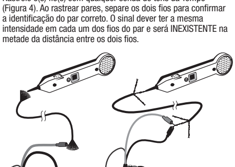
Figure 4a. Rastreamento de cabos
