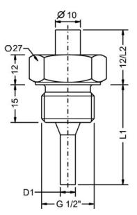
Type 4 / type 5 – Thread ISO 228-1 –  $G^{1/2}$ " B – front-flush gasket
